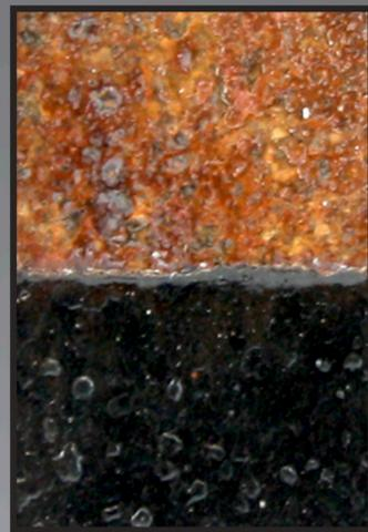
**Convierte el óxido en fosfato de hierro. Disuelve óxidos metálicos, detiene la corrosión y se puede pintar.**
